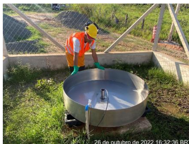
Foto 2 – Limpeza do reservatório sendo preenchido com água. (Data: 26/10/2022).
